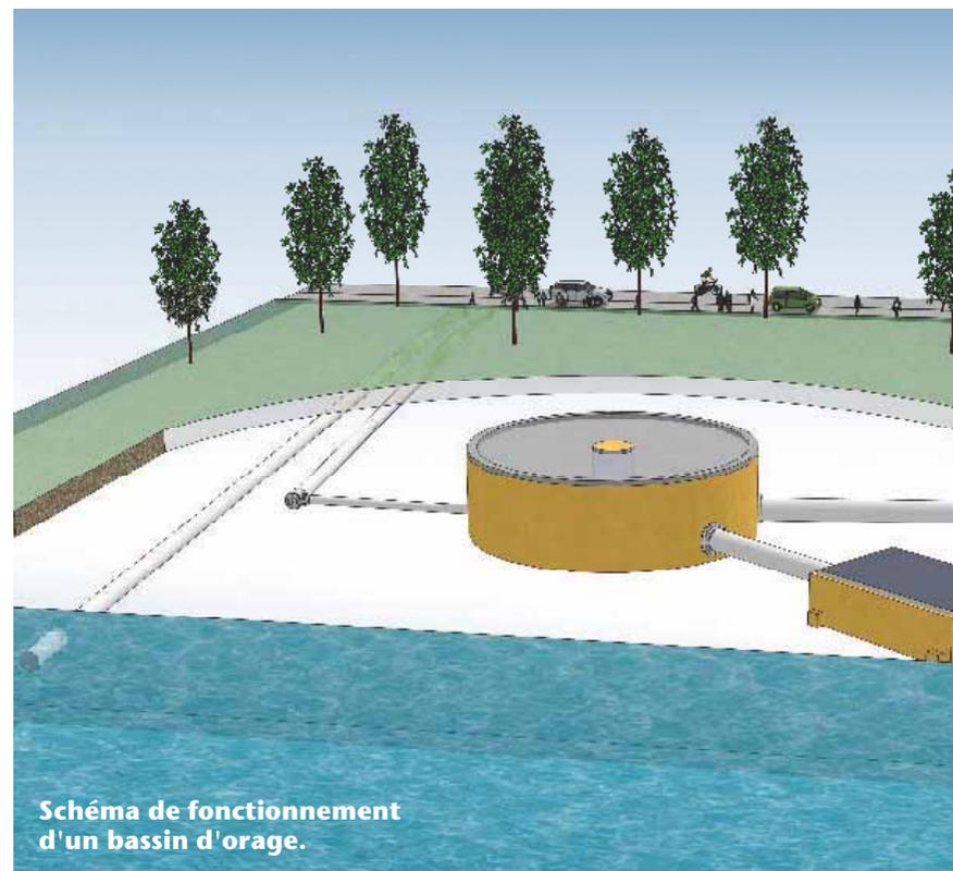
**Schéma de fonctionnement d'un bassin d'orage.**
