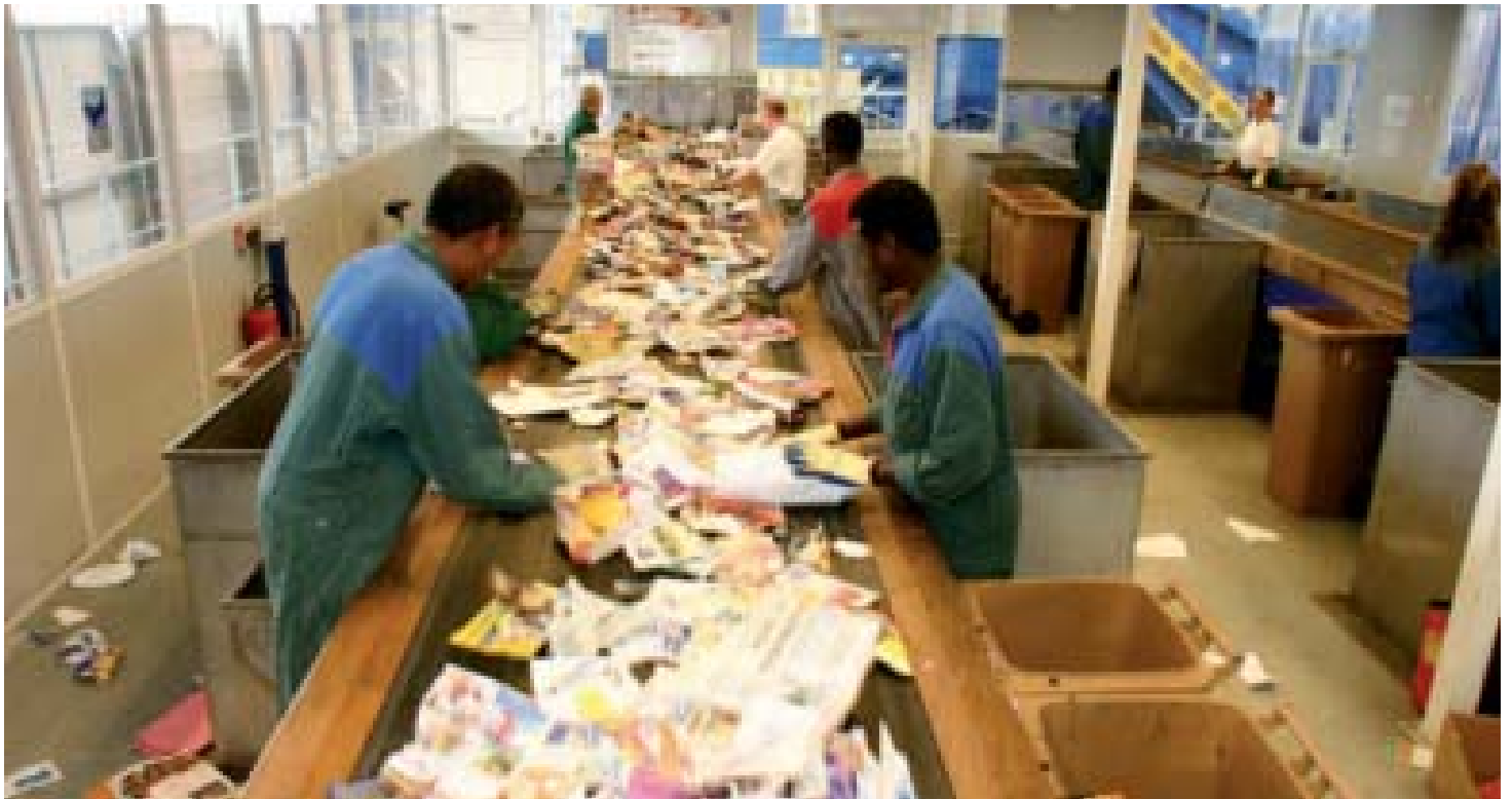
La ligne de tri du centre de Villers Saint-Paul. Les agents procèdent à une vérification des arrivages
