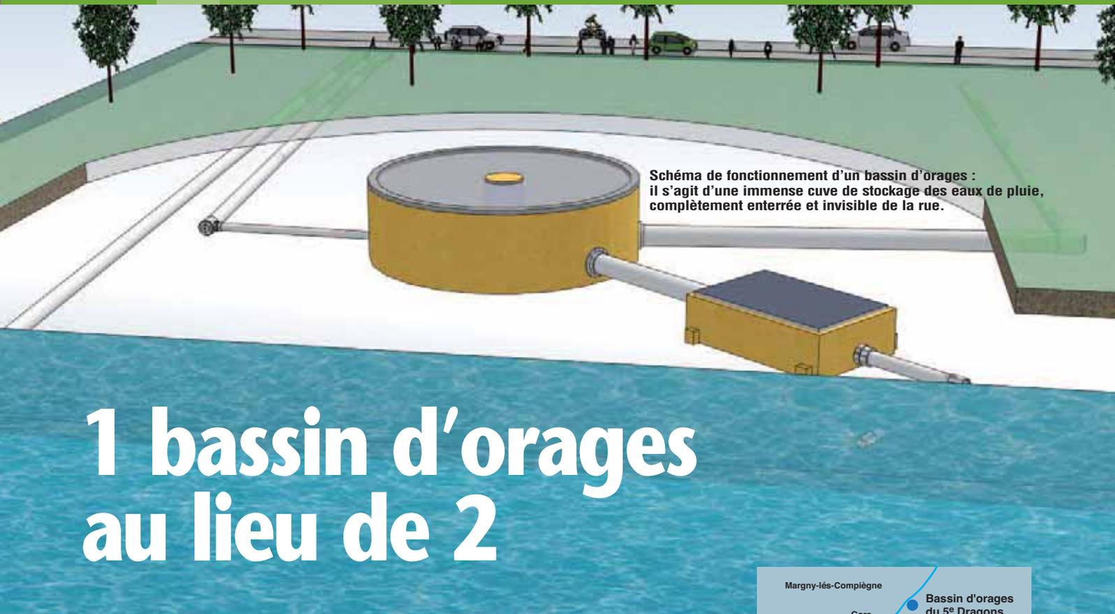
Schéma de fonctionnement d'un bassin d'orages : il s'agit d'une immense cuve de stockage des eaux de pluie, complètement enterrée et invisible de la rue.
